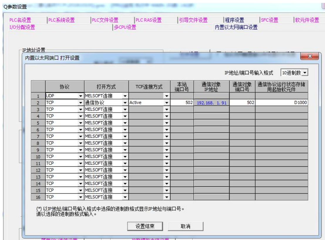
图 2.4.1 MODBUS-TCP 从站通讯状态存储器设置（示例：D1000）
